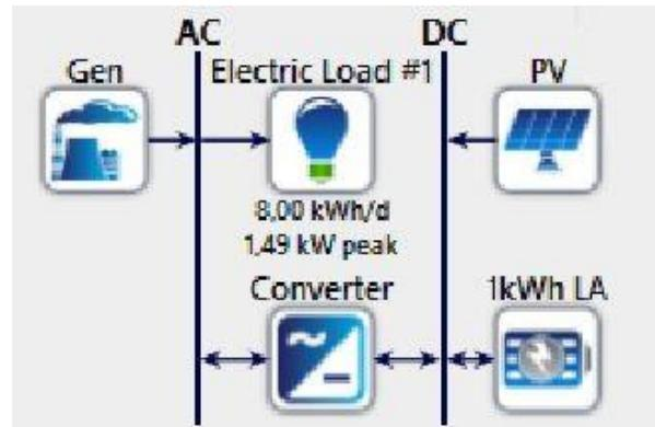
**Slika 10.** Shematski prikaz FN sustava
