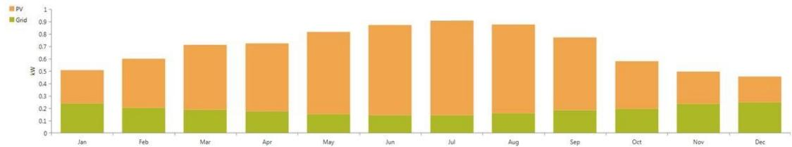
**Slika 13.** Prosječna mjesečna proizvodnja električne energije pomoću FN panela i elektroenergetske mreže
