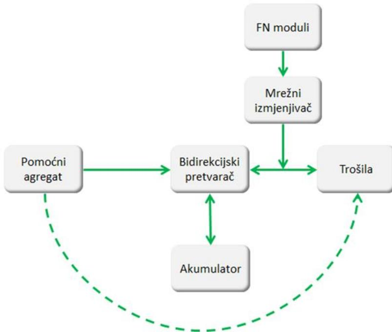
Slika 7. Konfiguracija sustava s mrežnim izmjenjivačem [5]
