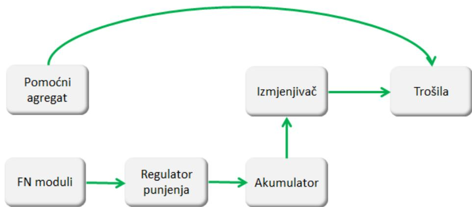
Slika 5. Konfiguracija sustava bez bidirekcijskog pretvarača [5]
