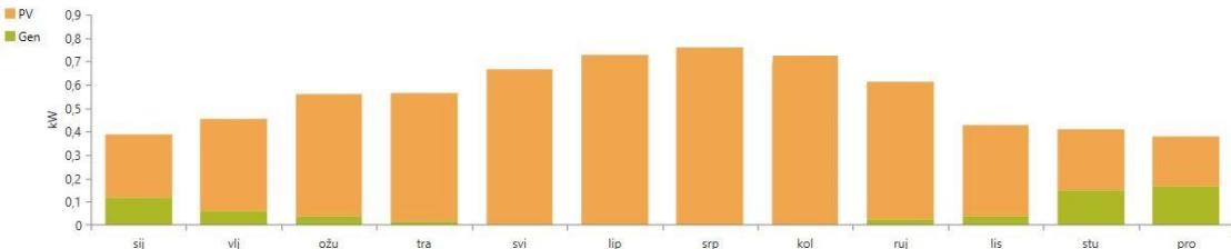
**Slika 12.** Prosječna mjesecačna proizvodnja električne energije pomoću FN panela i generatora
