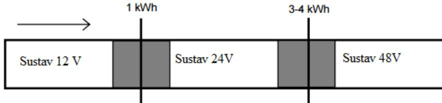
**Slika 8.** Preporučeni napon sustava u ovisnosti o dnevnom opterećenju [6]
