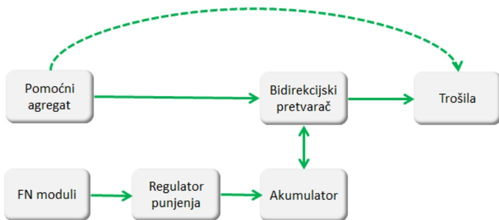
**Slika 6.** Konfiguracija sustava s bidirekcijskim pretvaračem [5]
