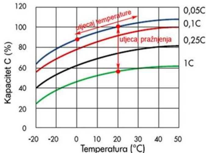
Slika 9. Ovisnost kapaciteta o struji pražnjjenja i temperaturi [21]
