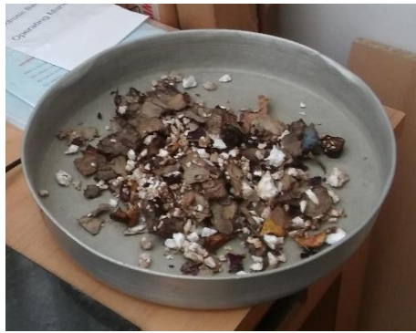
Slika 14. Dio uzorka za ispitivanje vlažnosti – nakon sušenja
