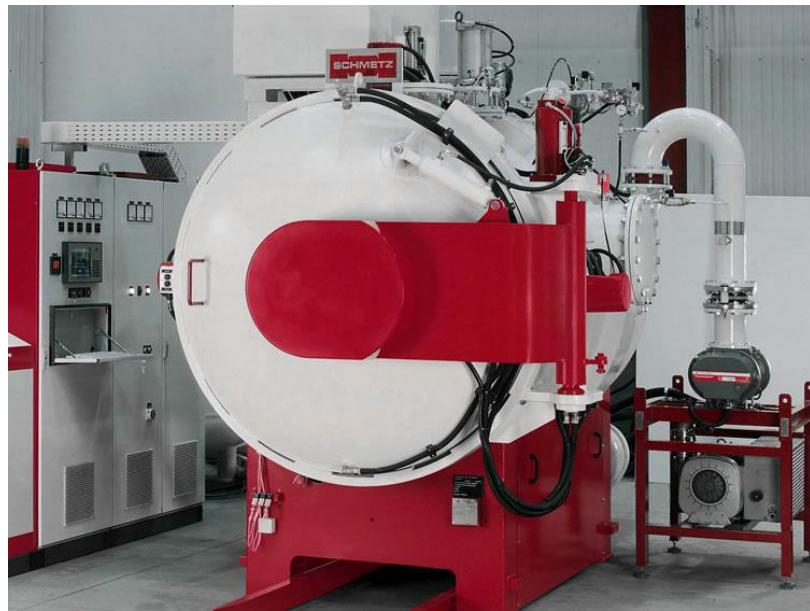
Slika 8 Vakuumska horizontalna jednokomorna peć [33]
