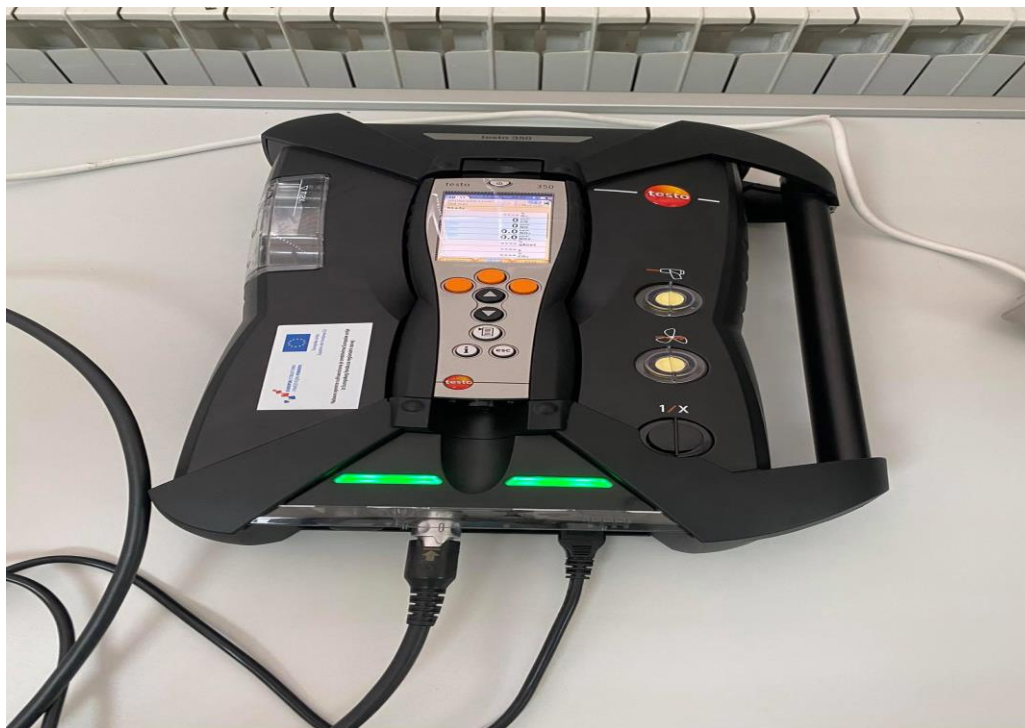
Slika 6. Analizator otpadnih plinova Testo 350
