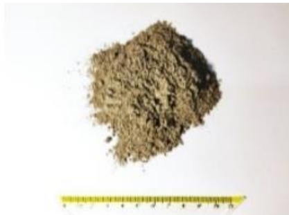
Slika 8: Leteći pepeo finije frakcije iz dimnjaka (elektrostatski ili vrećasti filter)
