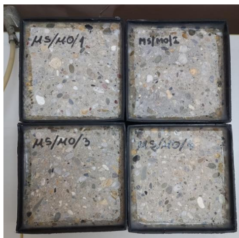
Slika 20: Silikonirani uzorci za ispitivanje otpornosti na mraz i sol
