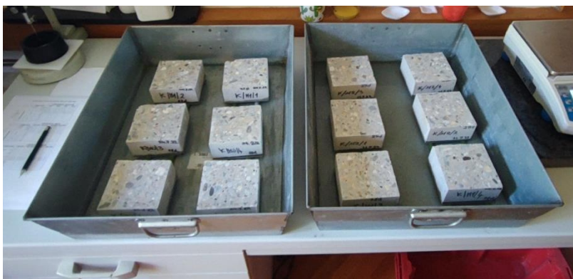
Slika 17: Uzorci za kapilarno upijanje
