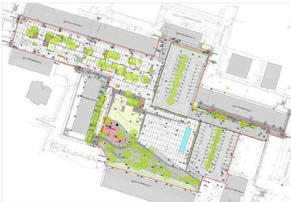
Slika 13. Projektno rješenje uređenja Trga kralja Tomislava u Puli s primjenom integralnog upravljanja oborinskim vodama (Izvor: [1])
