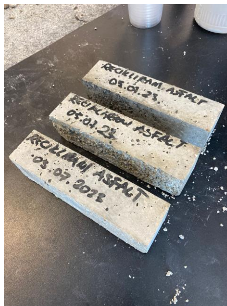
Slika 23. Prizme s agregatom od recikliranog asfalta
