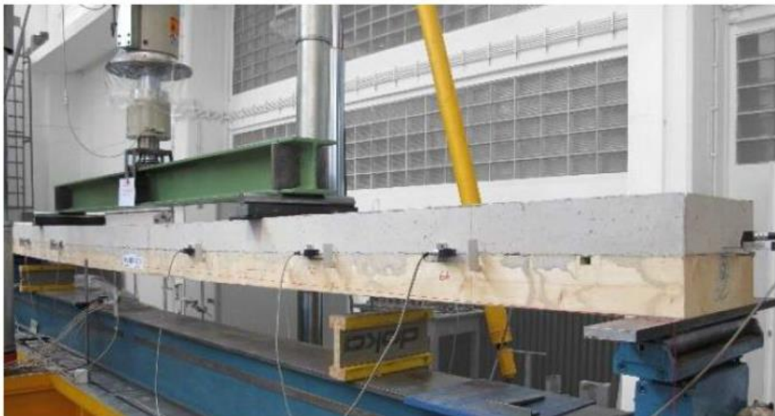
Slika 33. Laboratorijsko ispitivanje velikih uzoraka sa zasječenim spojevima [33]
