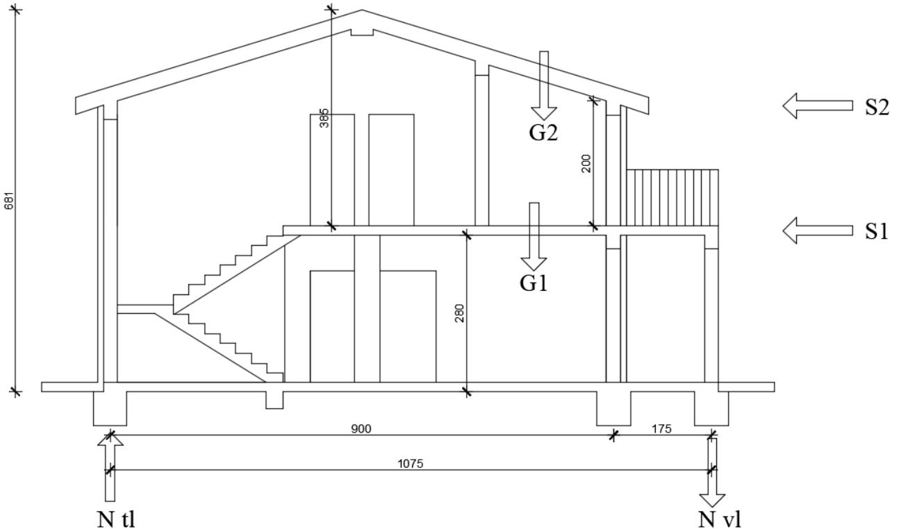
Potresne sile proračunate su po pojednostavljenom postupku. Građevina se nalazi u području Splita za koje se uz povratni period od 475 godina očekuje potres sa ubrzanjem tla  $a_g=0.2g$ . Građevina je temeljena na stjenovitom tlu, dakle pripada klasi tla A, pa slijedi:
