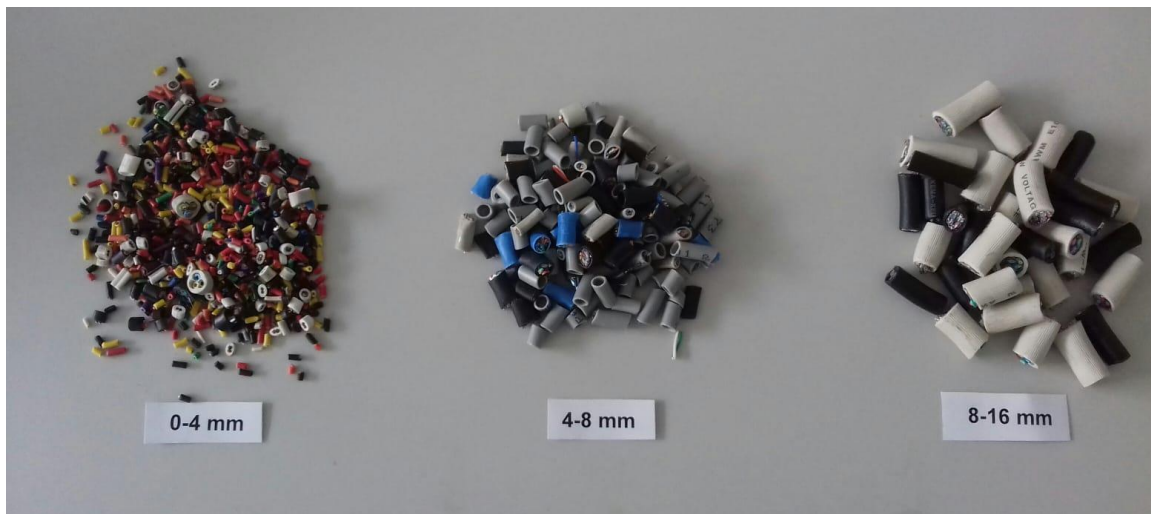
Slika 37 PVC kabeli korišteni za mješavine M1 – M6
