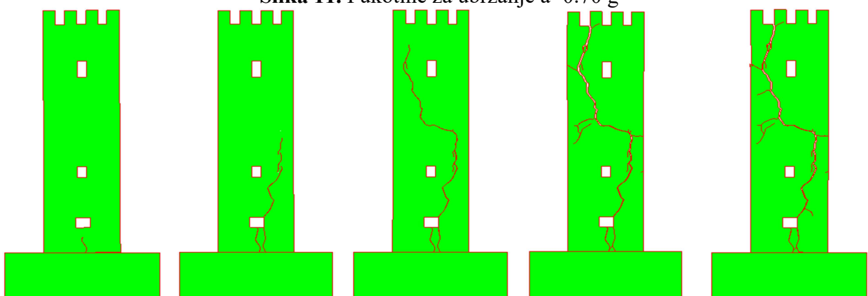
Slika 11. Pukotine za ubrzanje a=0.70 g
