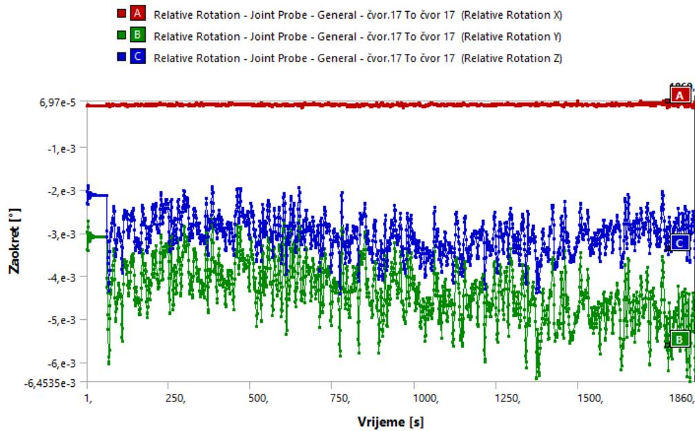
**3.52 Zaokreti montažnog spoja**
