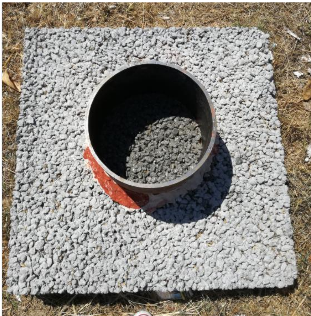
Slika 4.18 Čelični prsten postavljen na porozno – betonsku ploču
