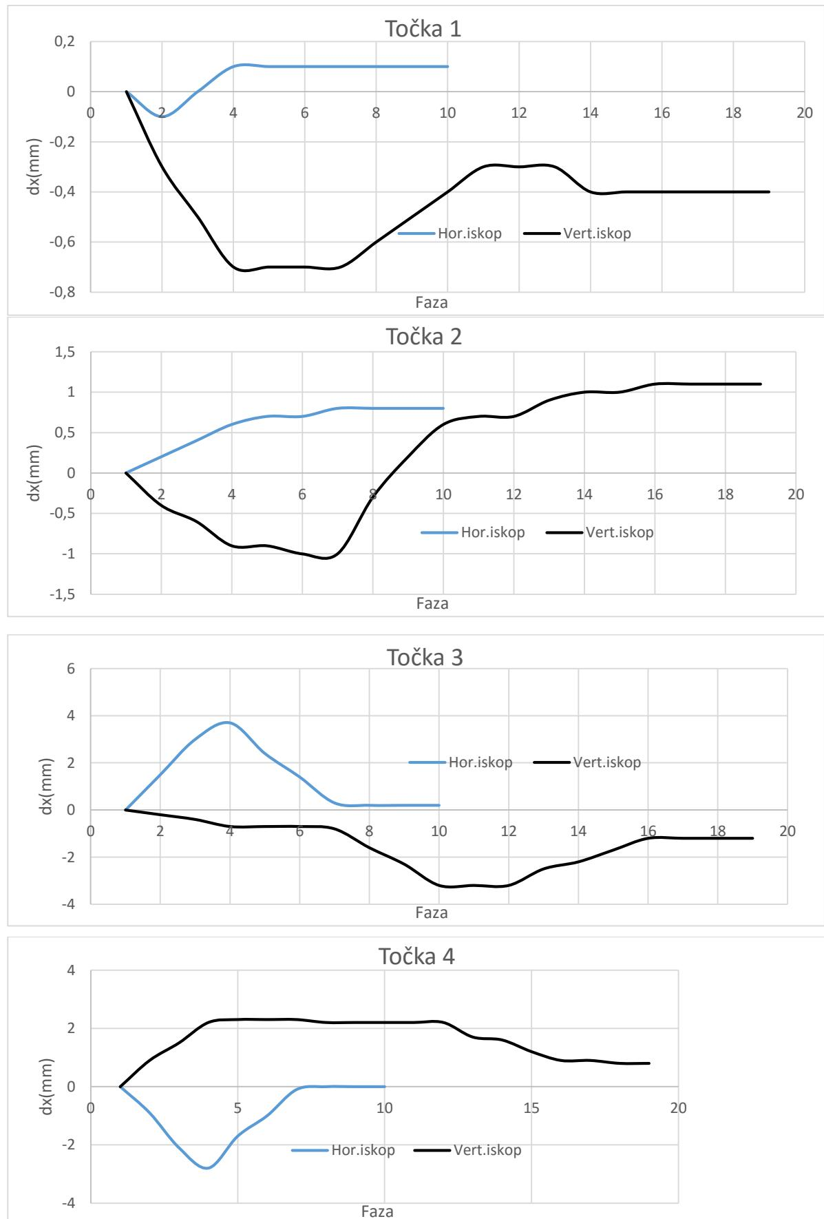
Slika 87. Usporedba pomaka točaka 1,2,3,4  $dx$  (mm)
