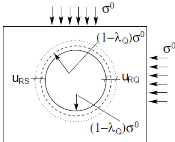
Slika 6.Naprezanja kod dubokog kružnog tunela
