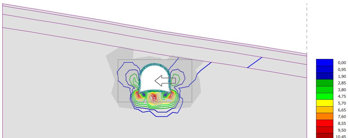
Slika 92. Plastične deformacije uslijed deformiranja  $\epsilon_{pl}$  (%)
