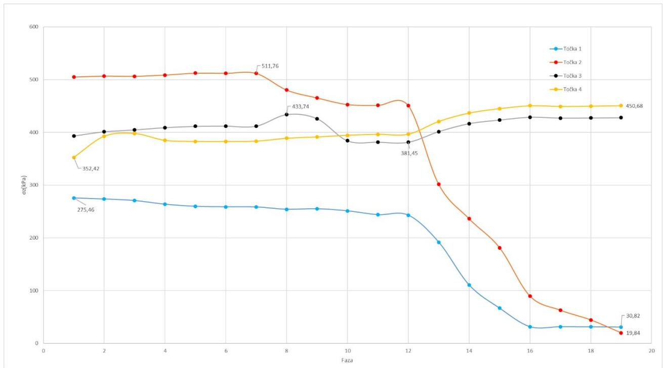
Slika 79. Naprezanja na konvergencijskim točakama po fazama  $\sigma_z$  (kPa)
