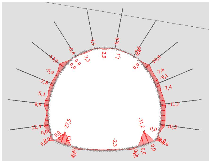
Slika 83. Momenti primarne podgrade za vertikalni iskop (kNm/m)
