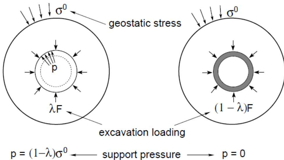
Slika 3.Efekt postepenog očvršćivanja u blizini iskopa
