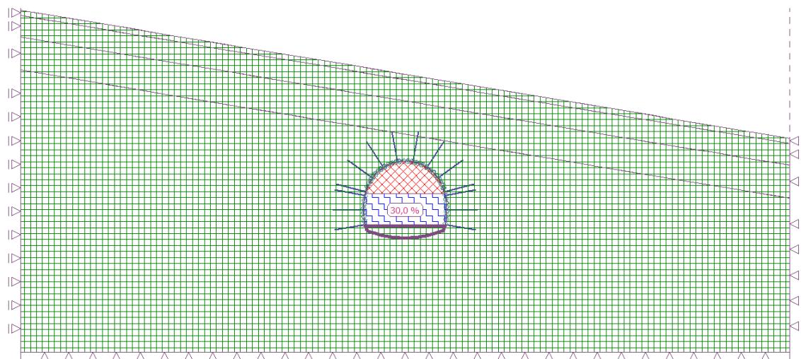
Slika 32. Deaktivacija 30% unutarnjih sila iz srednjeg dijela tunela
