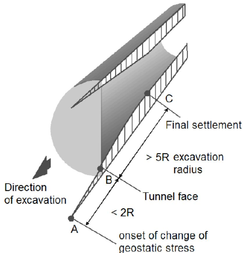
Slika 1.Diferencijalni pomaci krune i dna tunela s napretkom iskopa
