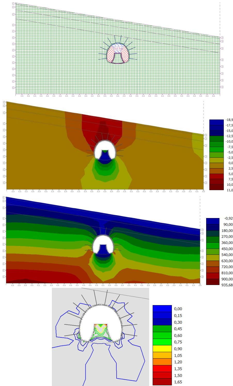
Slika 73.a)Deaktivacija preostalih 30% unutarašnjih sila iz gornjeg središnjeg dijela; b)Pomaci  $dz$  (mm); c)Naprezanja u tlu  $\sigma_z$  (kPa); d)Plastične deformacije  $\epsilon_{pl}$  (%)
