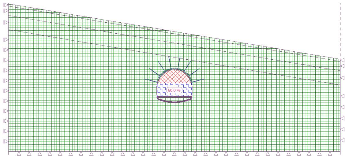
Slika 28. Deaktivacija 40% unutarnjih sila iz srednjeg dijela tunela
