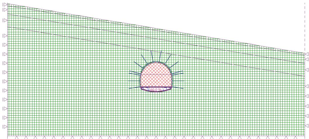
Slika 40. Deaktivacija 40% unutarnjih sila iz donjeg dijela tunela
