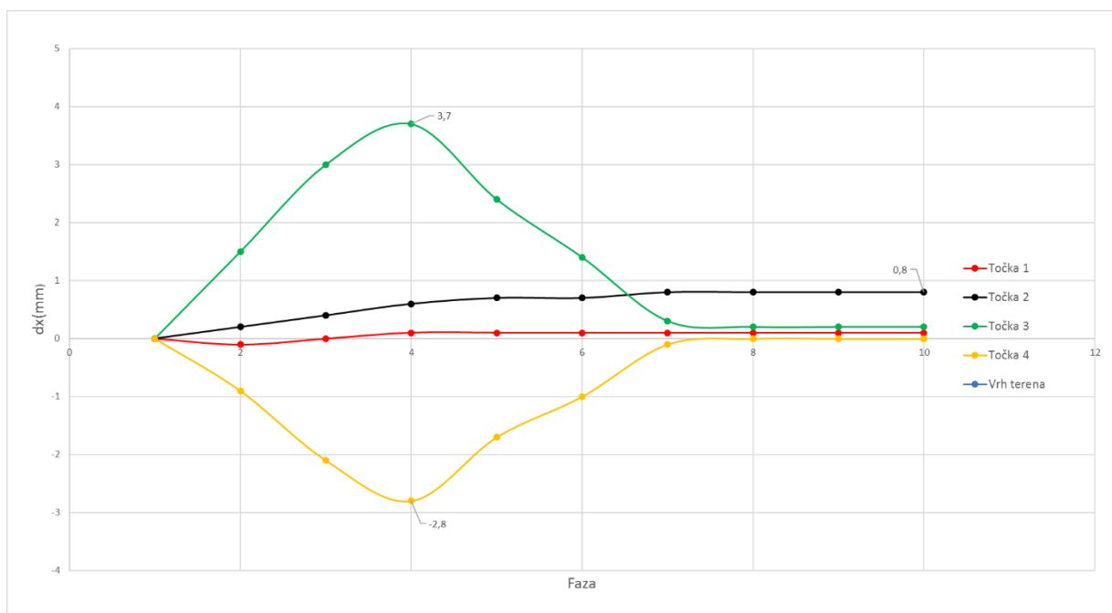
Slika 53. Pomaci konvergencijskih točaka po fazama  $dx$  (mm)
