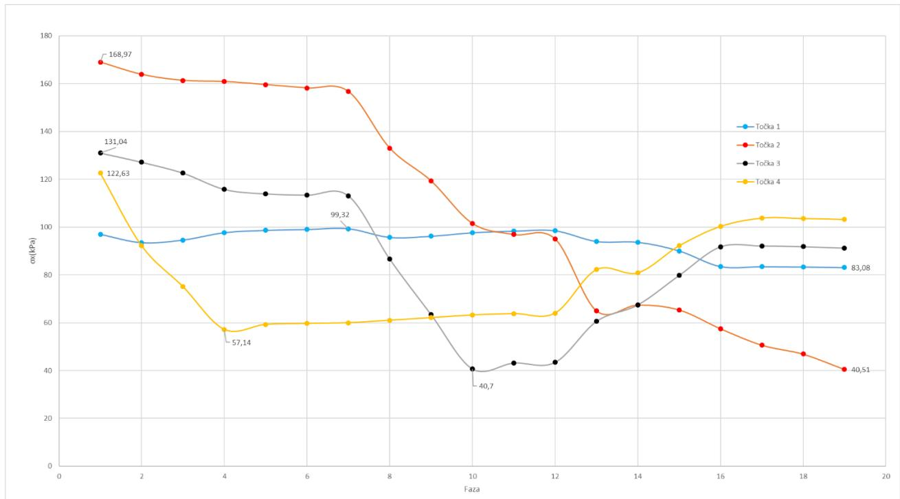
Slika 80. Naprezanja na konvergencijskim točakama po fazama  $\sigma_x$  (kPa)
