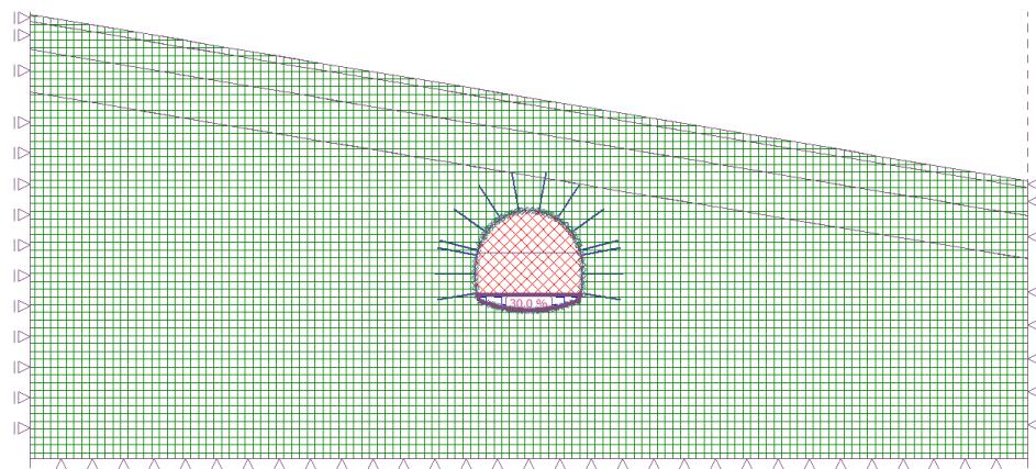
Slika 44. Deaktivacija 30% unutarnjih sila iz donjeg dijela tunela
