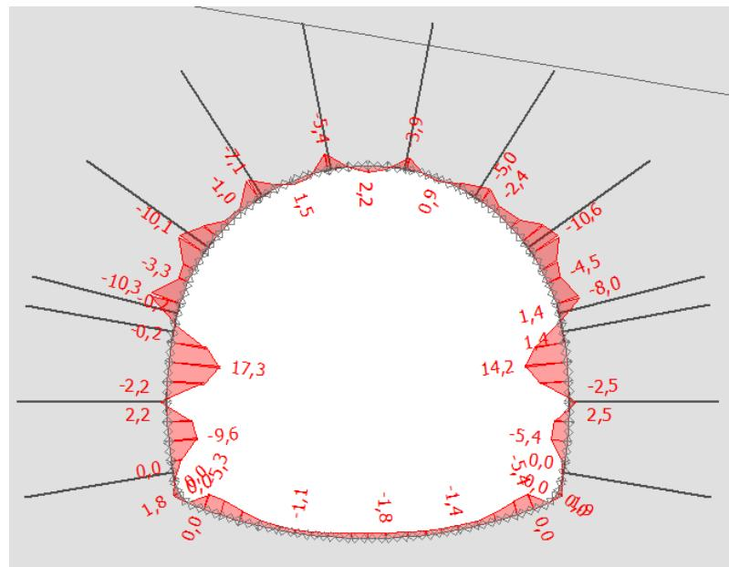
Slika 81. Momenti primarne podgrade za horizontalni iskop (kNm/m)
