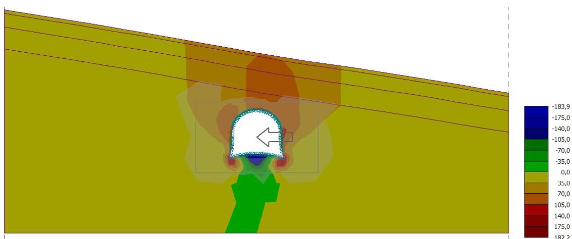
Slika 90. Deformirano stanje uslijed pomaka dz (mm)
