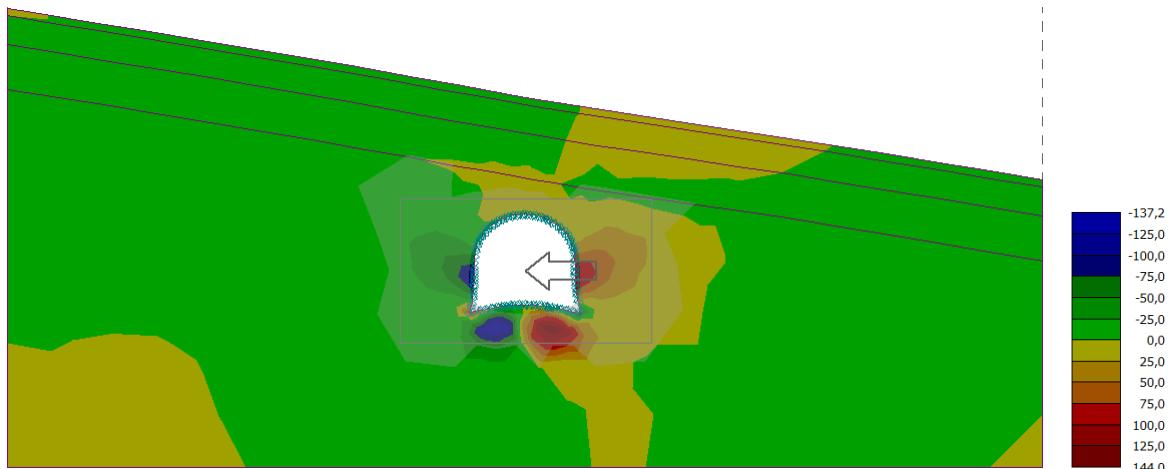
Slika 91. Deformirano stanje uslijed pomaka  $dx$  (mm)
