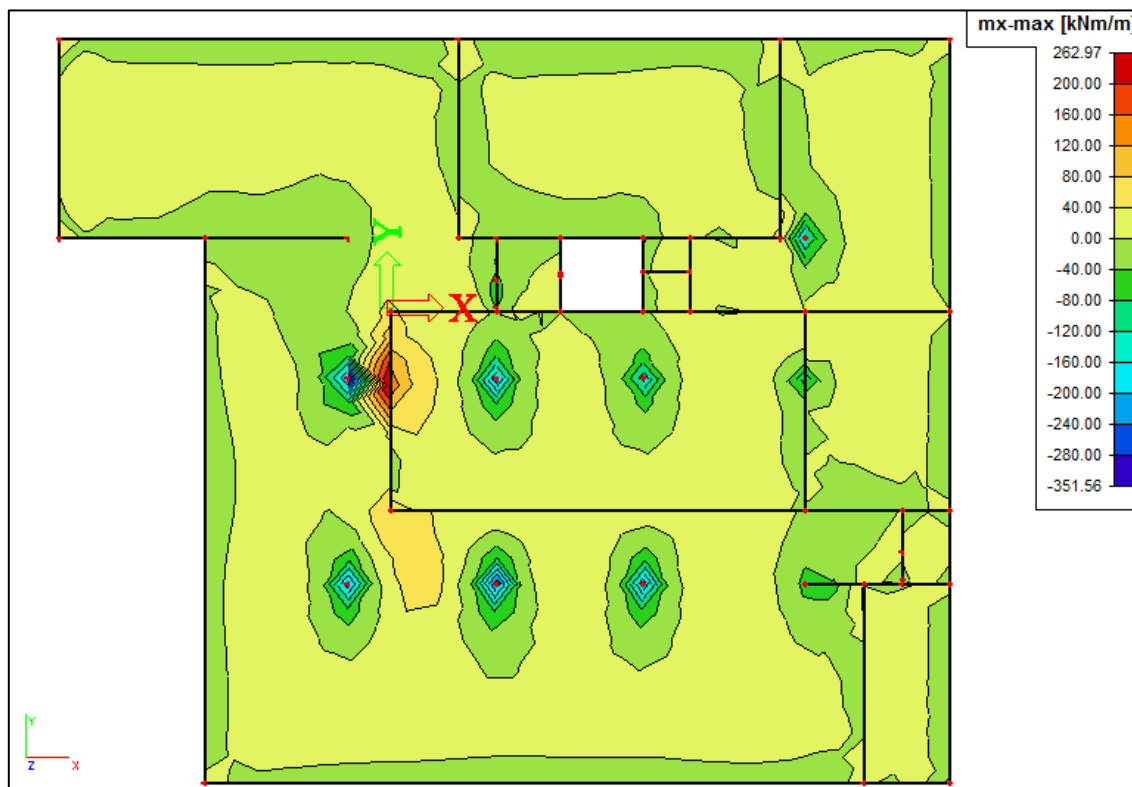
Slika 140. Dijagram momenta savijanja M_x (kNm/m')
