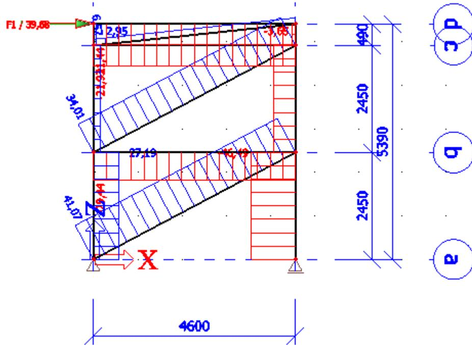
Slika 32. Dijagram uzdužnih sila  $N$  na bočni spreg
