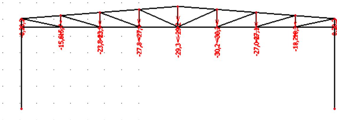
Slika 1.8 Vertikalni progib rešetke
