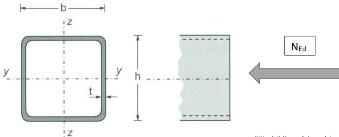
Slika 6.3 Poprečni presjek grede
