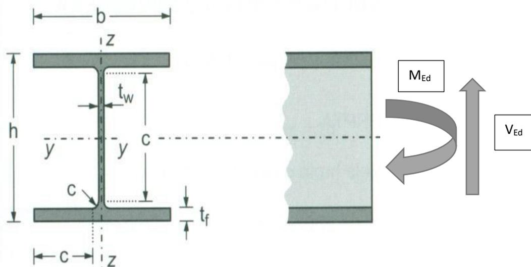
Slika 6.1 Poprečni presjek stupa
