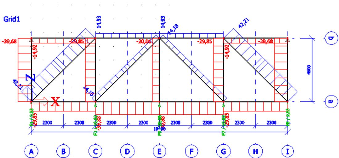
Slika 6.7. Raspored krovnih spregova i dijagram uzdužnih sila
