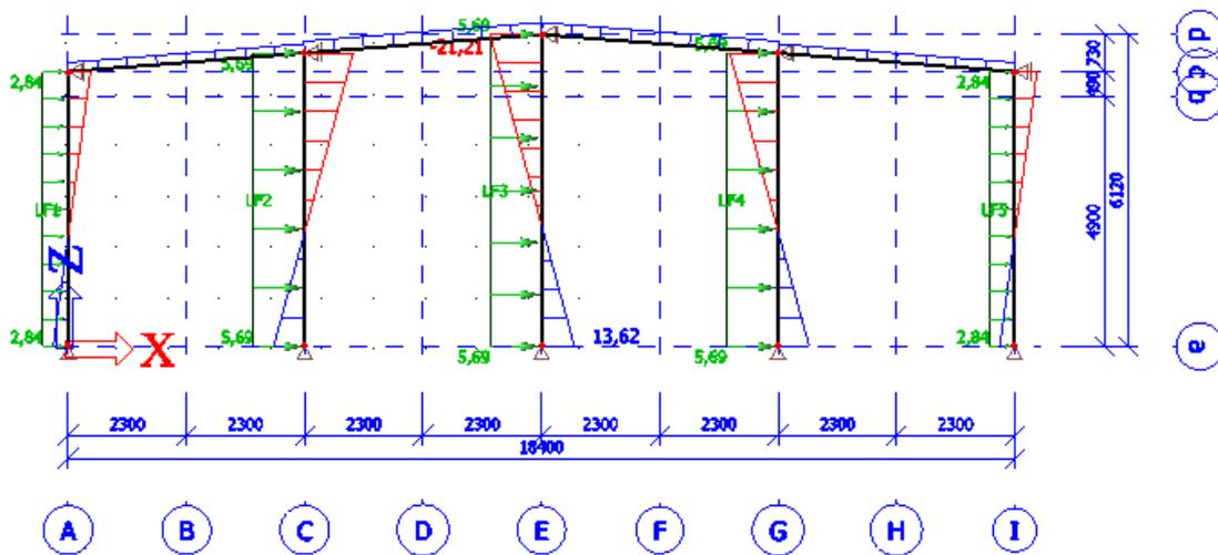
Slika 27. Dijagram poprečnih sila V na zabatni stup
