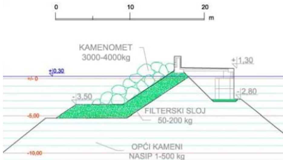
Slika 2.1. Poprečni presjek luobrana [1]
