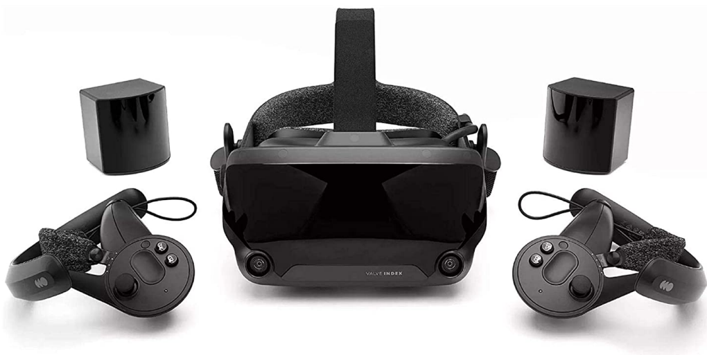
Slika 7 - Valve Index s kontrolerima i baznim stanicama
