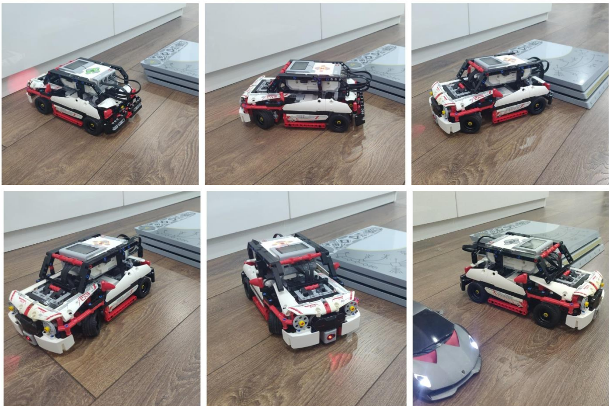
Slika 20: Izbjegavanje prepreke i pokretanje manevara
