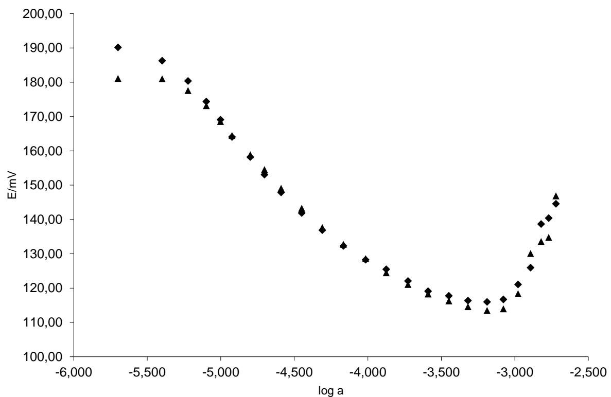
Slika 11. Odziv MWCNT coated wire tenzidne elektrode na SDS za dva nezavisna mjerjenja
