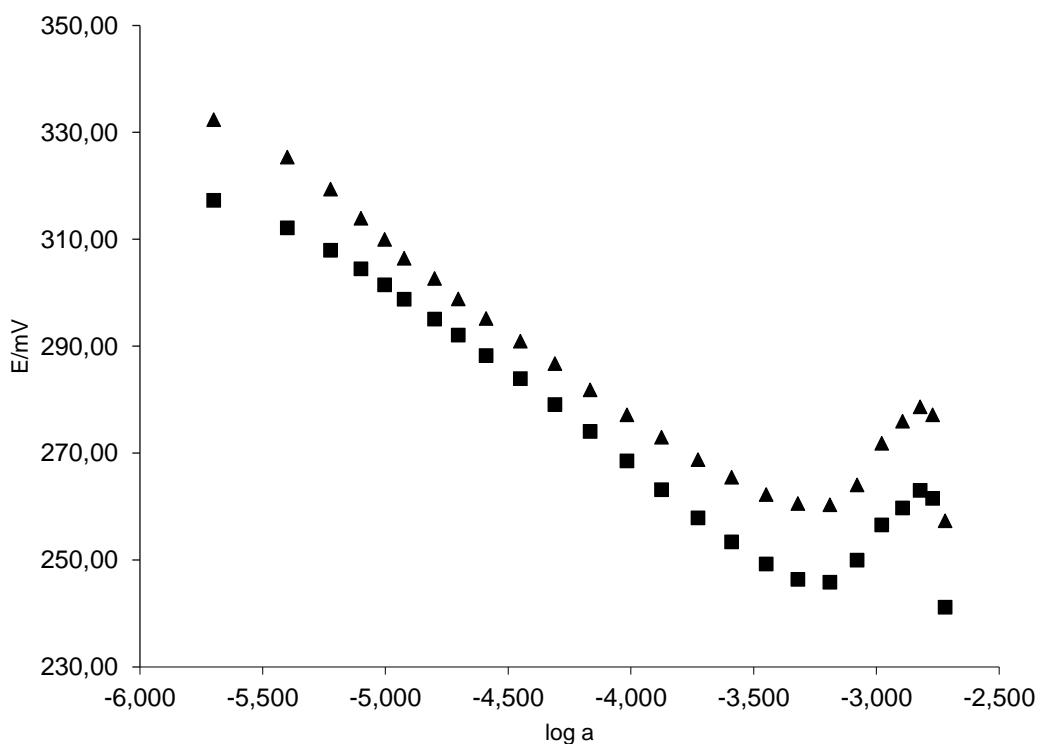
Slika 10. Odziv MWCNT tenzidne elektrode na CPC za dva nezavisna mjerena.
