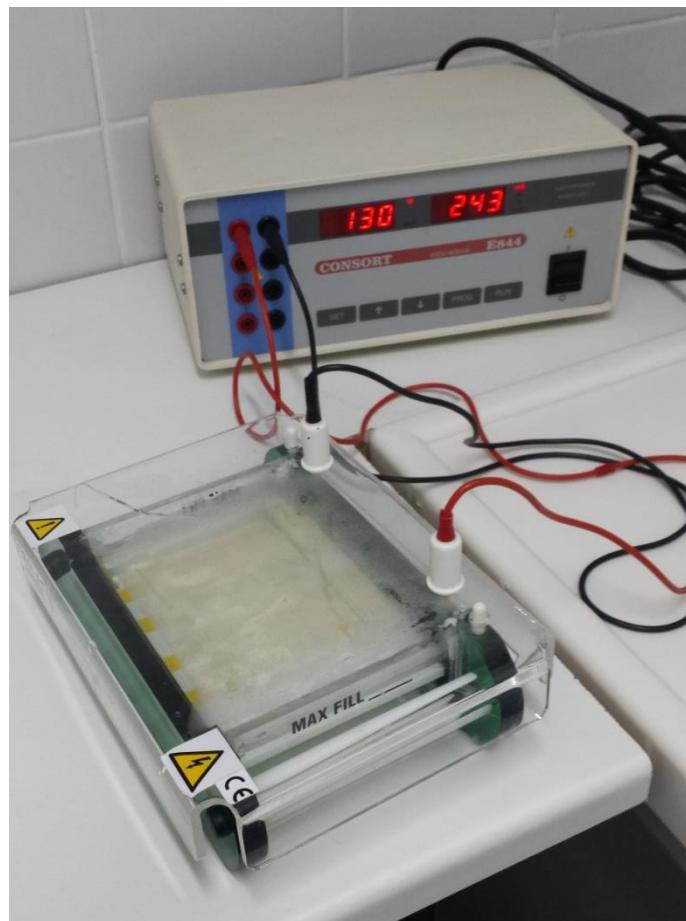
**Slika 8. Provodenje elektroforeze pri jakosti struje od 130 V u vremenskom razdoblju od 30 min**
