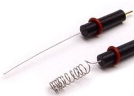
Slika 3.3. Protuelektroda – platinska žica.
