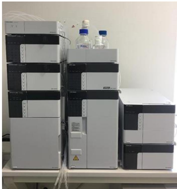
**Slika 15.:** UPLC uređaj korišten u radu (proizvođač Shimadzu)
