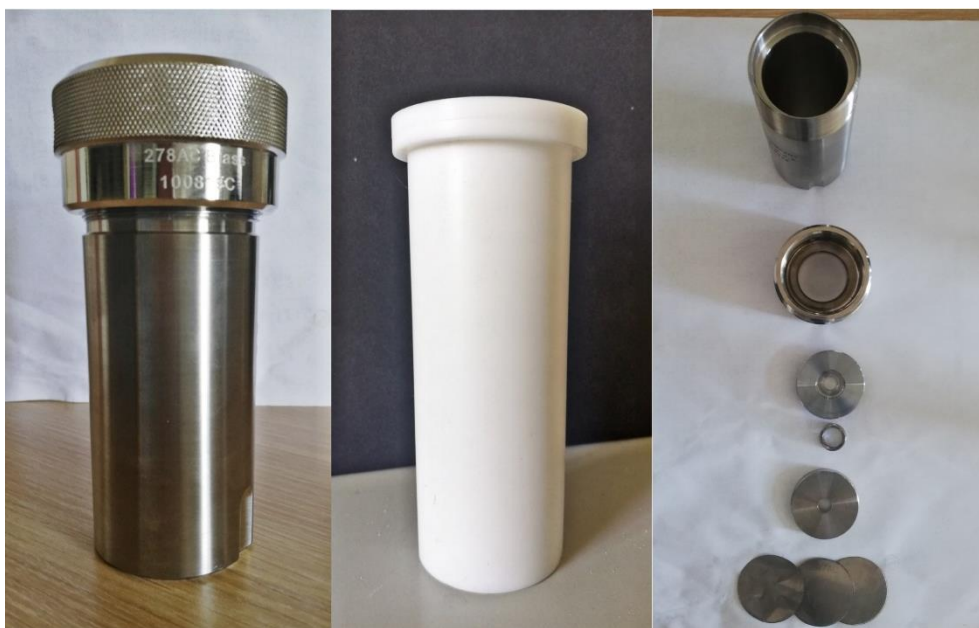
Slika 15. Prikaz korištenog autoklava i njegovi sastavni dijelovi.
