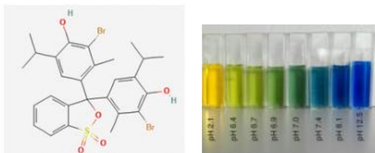
Slika 13. Struktura i boje bromtimol plavog pri različitim pH vrijednostima [33, 34].
