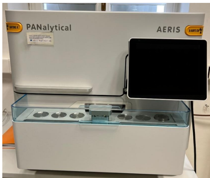
Slika 16. Panalytical Aeris Research difraktometar.
