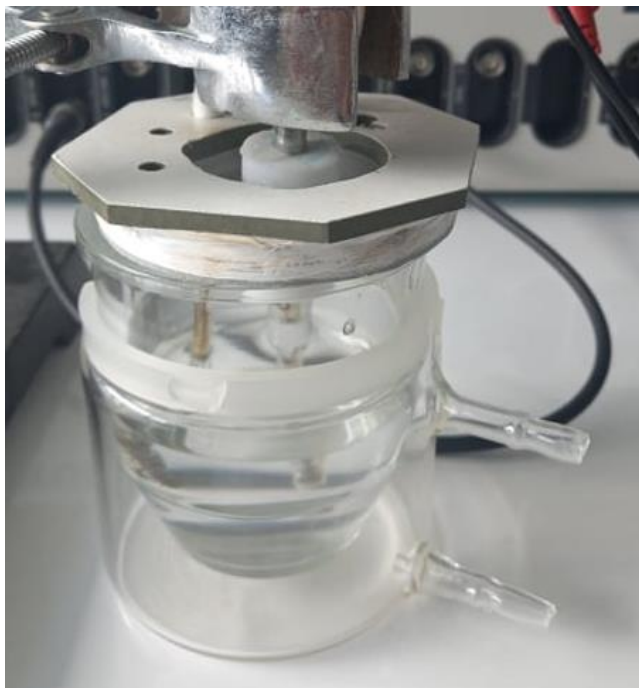
Slika 48. Prikaz elektrokemijske ćelije
