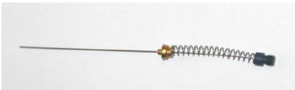
Slika 14. Plavo vlakno s ovojnicom PDMS/DVB [46]
