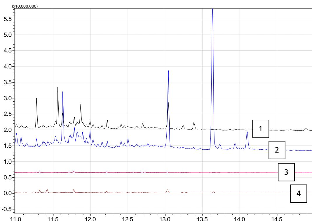
**Slika 11.** Usporedba četiri kromatograma (označeni brojevima 1-4) dobivenih analizom bioloških uzoraka mokraće uz dodatak medicinskog pripravka br. 1, koristeći obje ekstrakcijske tehnike:
