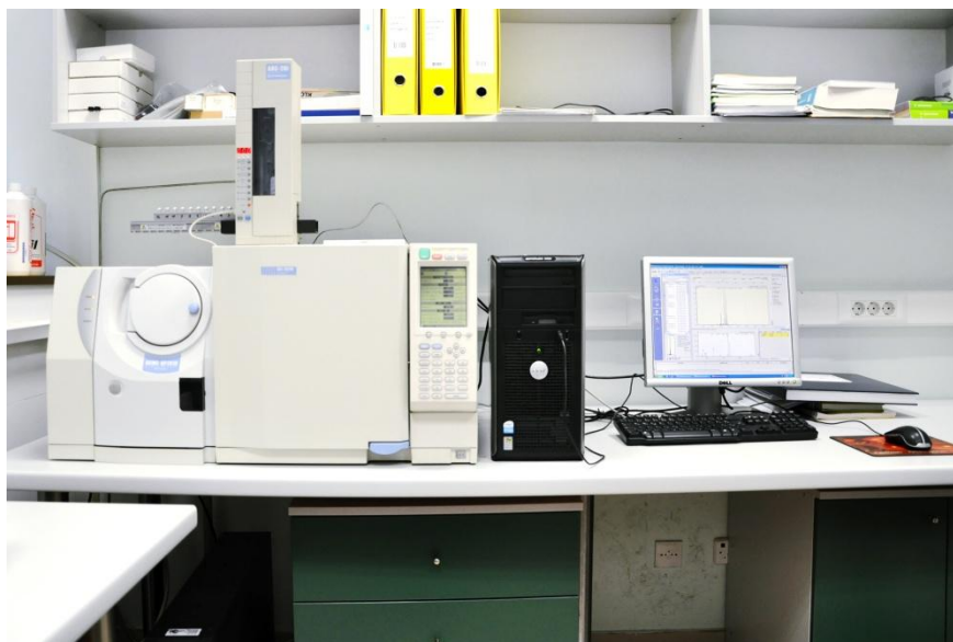
Slika 6. Plinski kromatograf sa spektrometrom masa; Shimadzu GCMS-QP2010
