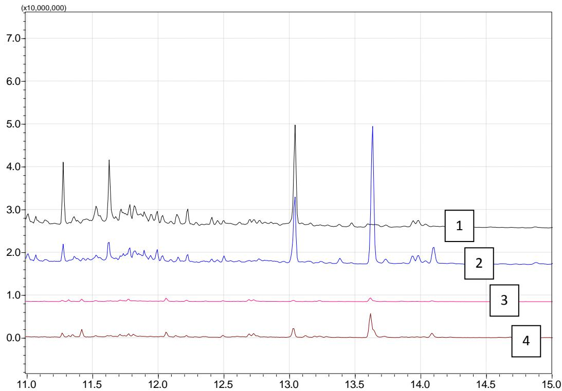
**Slika 12.** Usporedba četiri kromatograma (označeni brojevima 1-4) dobivenih analizom bioloških uzoraka mokrače uz dodatak medicinskog pripravka br. 2, koristeći obje ekstrakcijske tehnike:
