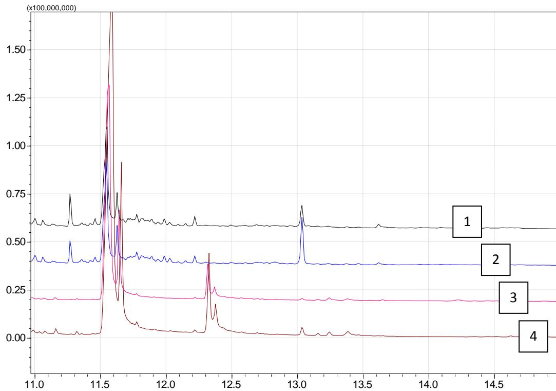
**Slika 14.** Usporedba četiri kromatograma (označeni brojevima 1-4) dobivenih analizom bioloških uzoraka seruma uz dodatak medicinskog pripravka br. 1, koristeći obje ekstrakcijske tehnike:
