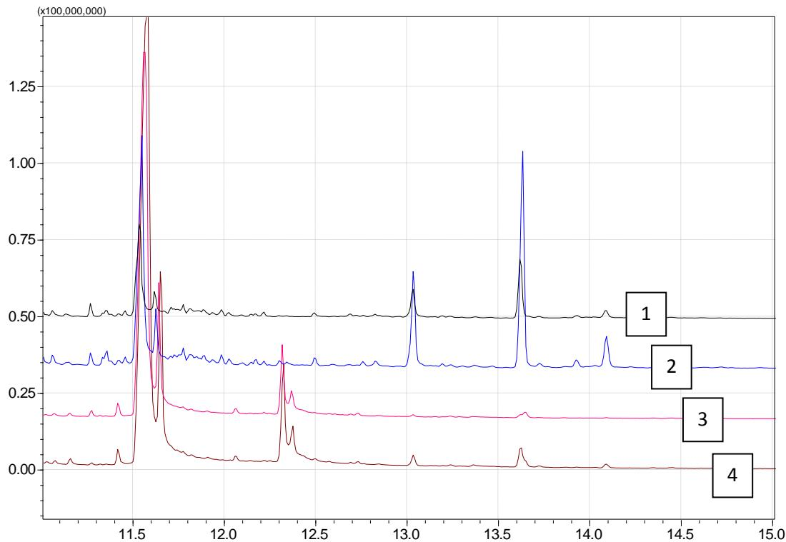
**Slika 15.** Usporedba četiri kromatograma (označeni brojevima 1-4) dobivenih analizom bioloških uzoraka seruma uz dodatak medicinskog pripravka br. 2, koristeći obje ekstrakcijske tehnike:
