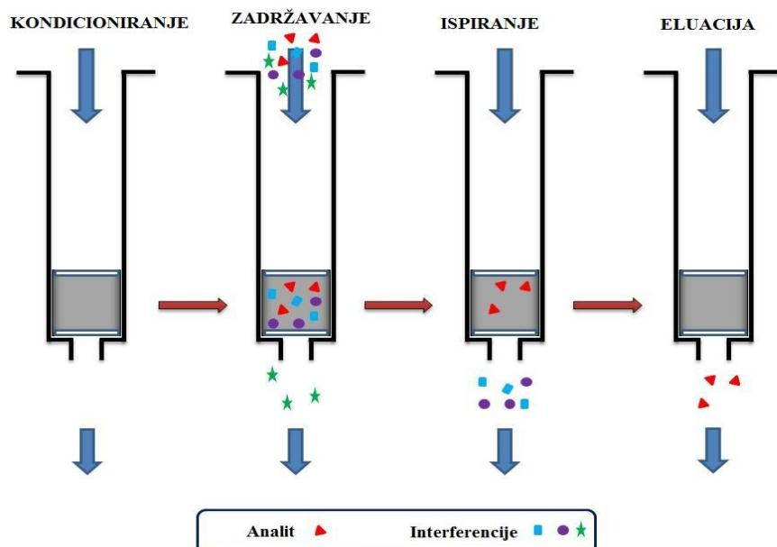
Slika 2. Priprema uzorka metodom ekstrakcije čvrstom fazom (SPE)
