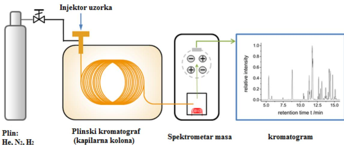
Slika 3. Shematski prikaz osnovnih dijelova vezane GC-MS tehnike (45)
