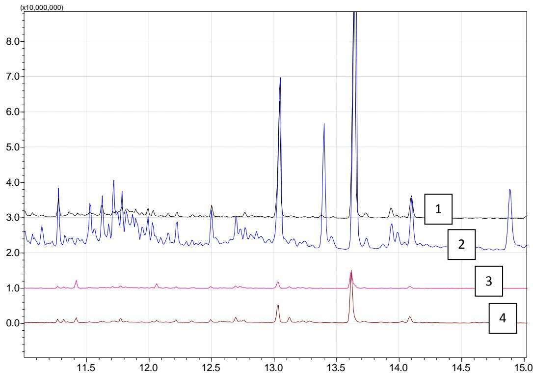
**Slika 13.** Usporedba četiri kromatograma (označeni brojevima 1-4) dobivenih analizom bioloških uzoraka mokrače uz dodatak medicinskog pripravka br. 3, koristeći obje ekstrakcijske tehnike:
