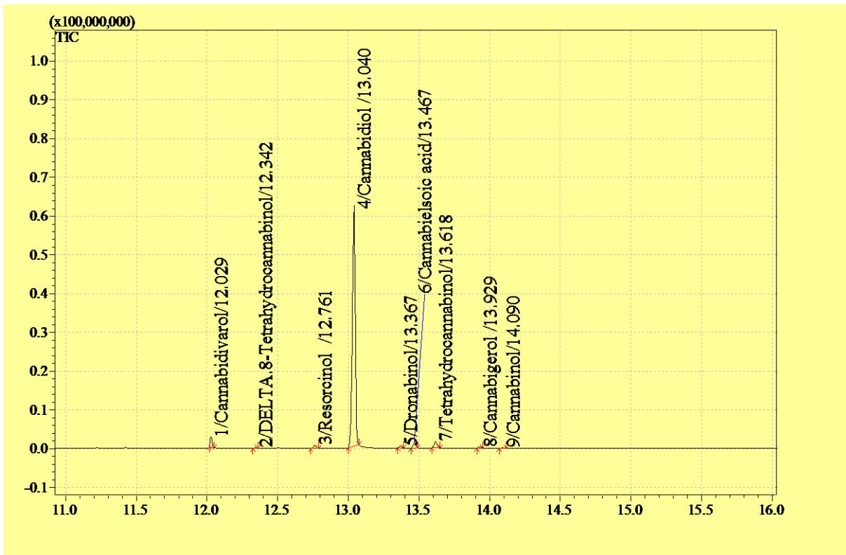
**Slika 7.** Uvećani prikaz dijela ukupnog ionskog kromatograma medicinskog pripravka br.1 analiziranog GC-MS tehnikom, s karakterističnim signalima i retencijskim vremenima za kanabidivarol (RT=12,029),  $\Delta$ -8-THC (RT=12,342), rezorcinol (RT=12,761), kanabidiol (RT=13,040), dronabinol (RT=13,367), kanabielskičnu kiselinu (RT=13,467), THC (RT=13,618), kanabigerol (RT=13,929) i kanabinol (RT=14,090).
