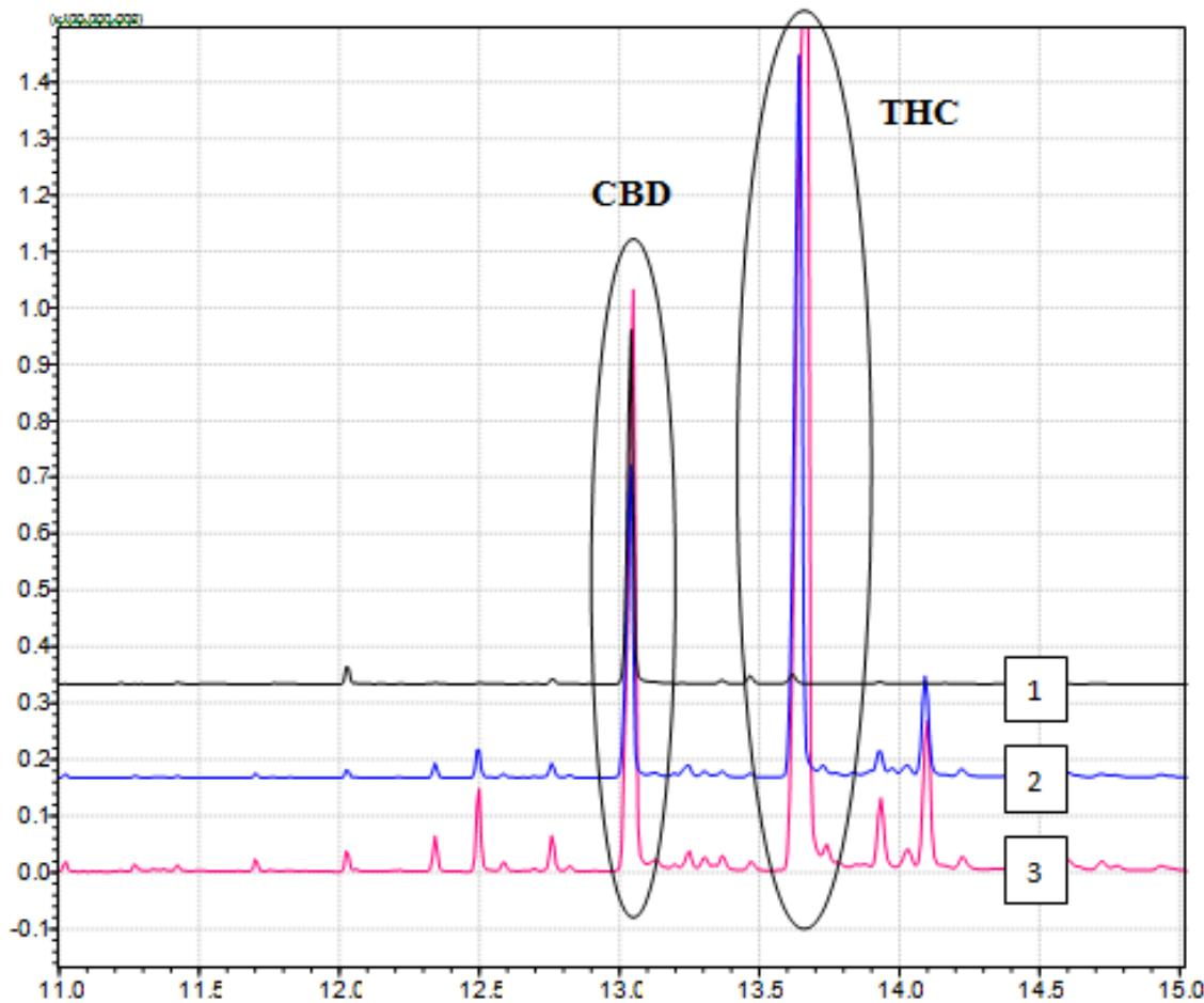
**Slika 10.** Usporedba tri kromatograma dobivena analizom tri različita medicinska pripravka (1, 2 i 3), analizirana GC/MS tehnikom (kromatogram označen brojem 1 - medicinski pripravak 1; kromatogram označen brojem 2 - medicinski pripravak 2; kromatogram označen brojem 3 - medicinski pripravak 3)
