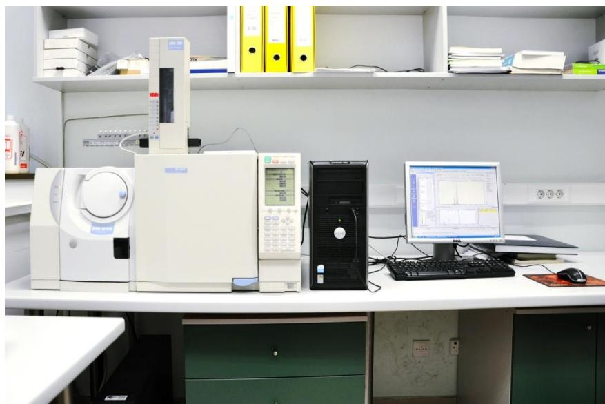
**Slika 6.** Plinski kromatograf sa spektrometrom masa; Shimadzu GCMS-QP2010
