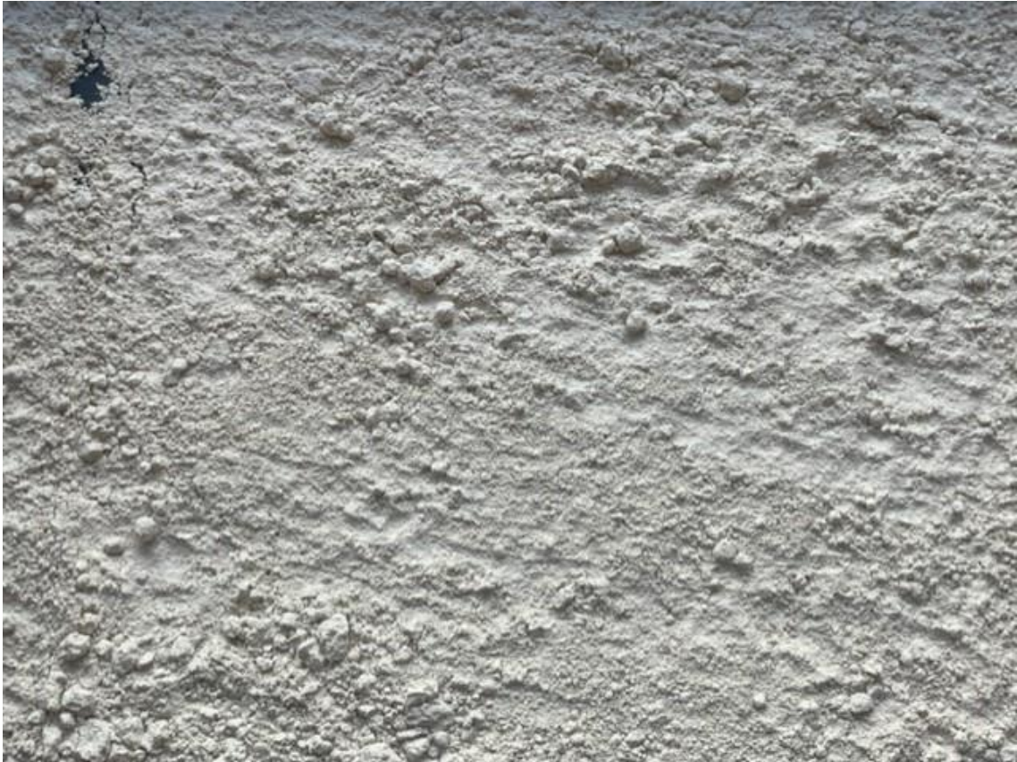
Slika 2.1. Usitnjene čestice zeolita NaX
