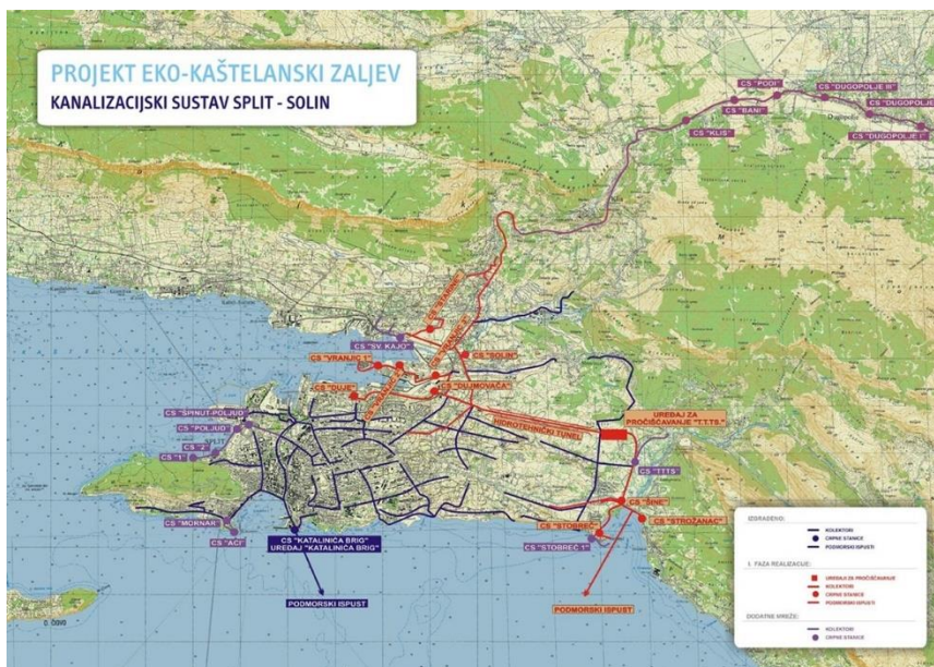
Slika 1.2. Kanalizacijski sustav Split - Solin. 7
