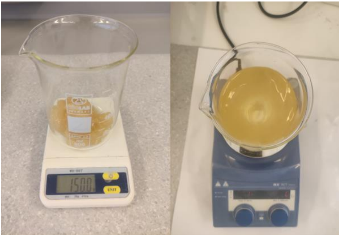
Slika 10. Priprava otopine meda određene koncentracije
