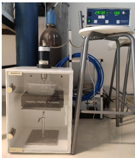
Slika 18. Ultrazvučna sonda (Ultrasonic homogeniser, Bandelin HD 2200, 20 kHz, 200 W)
