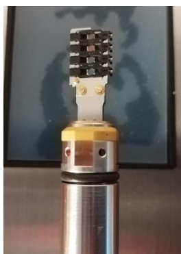
Slika 19. Nosač uzoraka (pripremljenih mrežica) za snimanje na TEM-u
