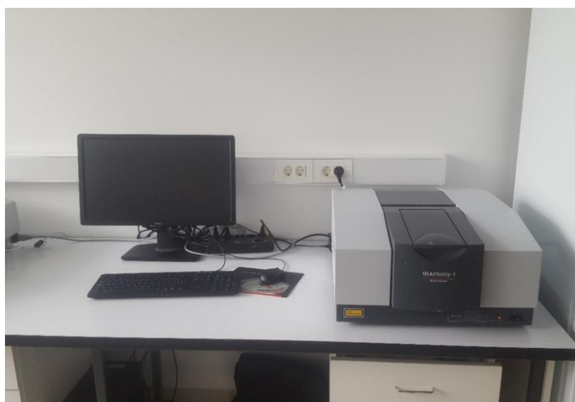
Slika 2.20. Infracrveni spektrofotometar s Fourierovom transformacijom (IRAffinity-1, Shimadzu, Japan).
