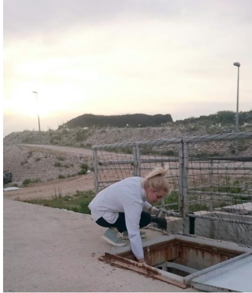
Slika 2.2 Uzorkovanje procjedne vode iz egalizacijskog bazena.
