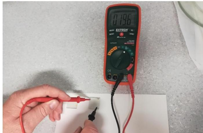
**Slika 26.** Određivanje vodljive strane stakalaca mjerjenjem otpora pomoću multimetra
