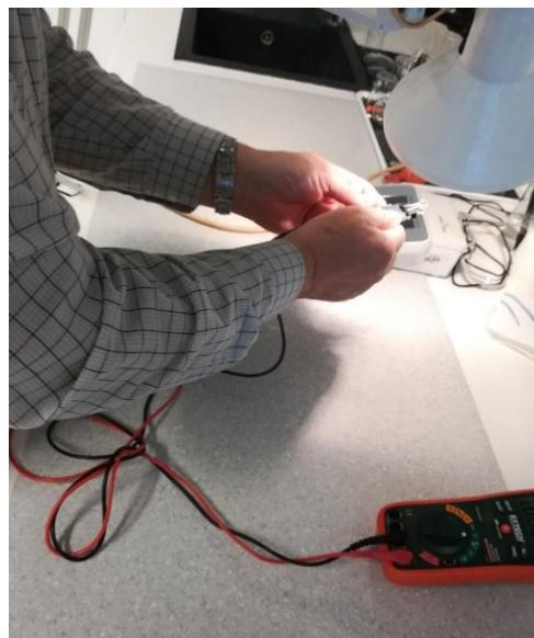
**Slika 35.** Mjerjenje fotoinduciranog napona pri umjetnom osvjetljenju pomoću multimetra
