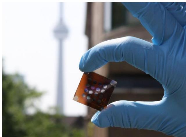
Slika 9. QD solarna čelija<sup>16</sup>
