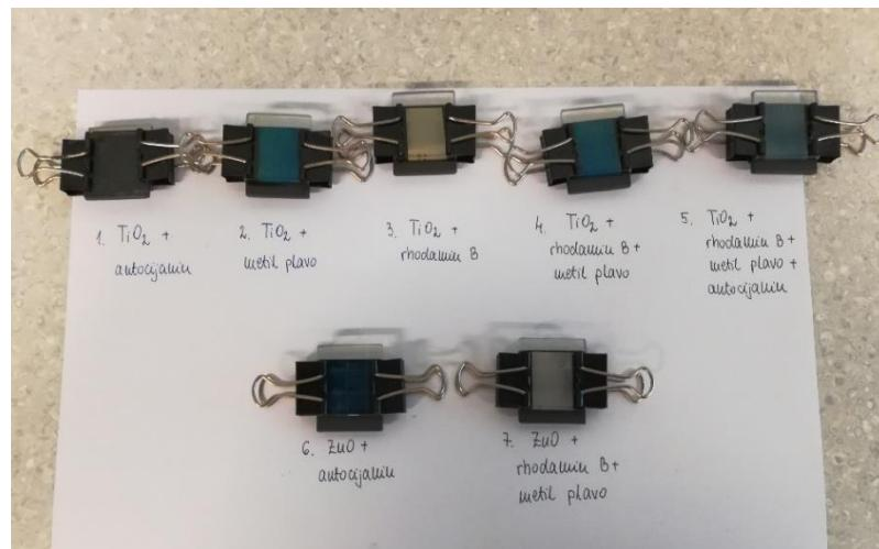
**Slika 34.** Izrađene solarne čelije
