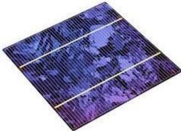
**Slika 5.** Polikristalna solarna čelija<sup>7</sup>
