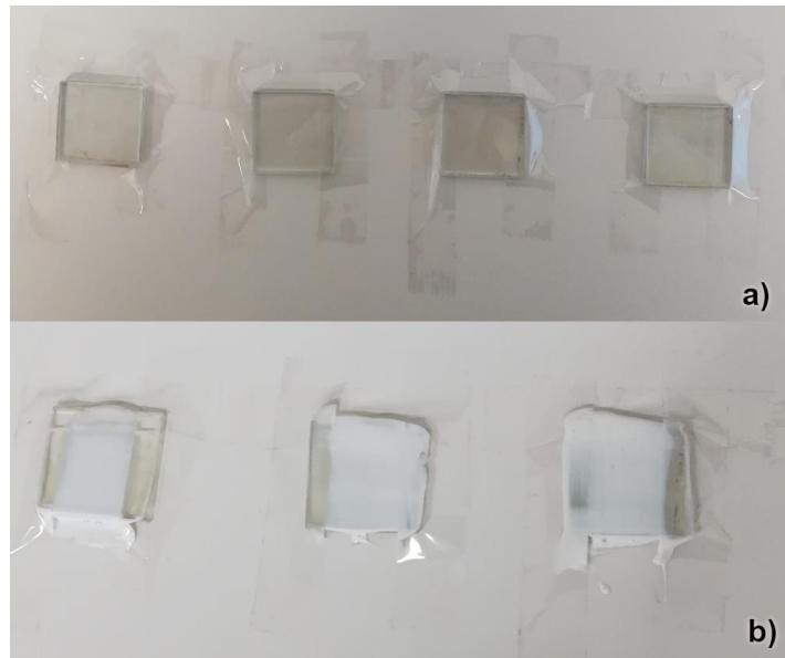
**Slika 27.** Nanošenje ljepljive trake (a); naneseni sloj paste (b)
