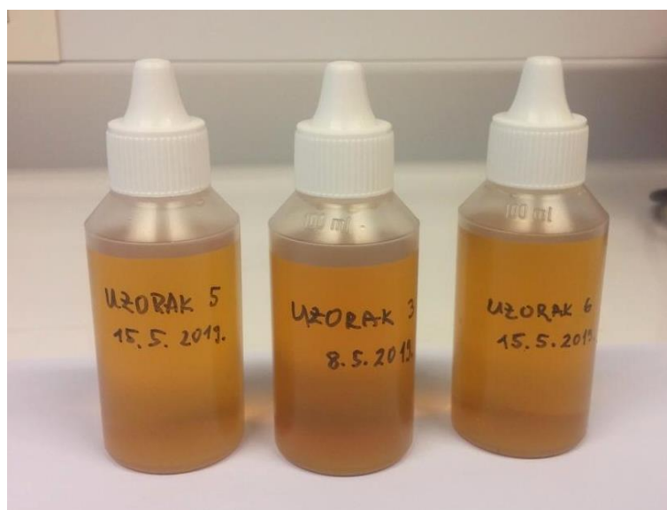
Slika 11. Uzorci koloidnog srebra dobivenog zelenim postupkom pomoću trinatrijevog citrata dihidrata, poredani s lijeva na desno počevši s najnižom koncentracijom
