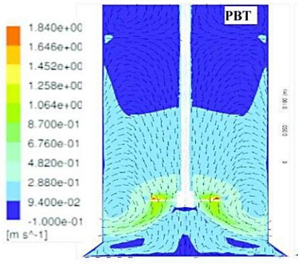
*Slika 26. Simulacija toka kapljevine kojeg razvija PBT miješalo simuliran primjenom CFD programa Ansys Fluent 17.2*
