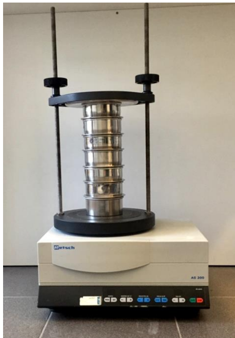
Slika 19. Aparatura za provedbu granulometrijske analize pomoću sita.
