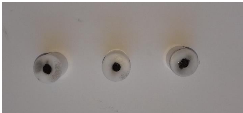
Slika 19 Formirani osjetilni slojevi na elektrodama od staklastog ugljika (pogled odozgo)
