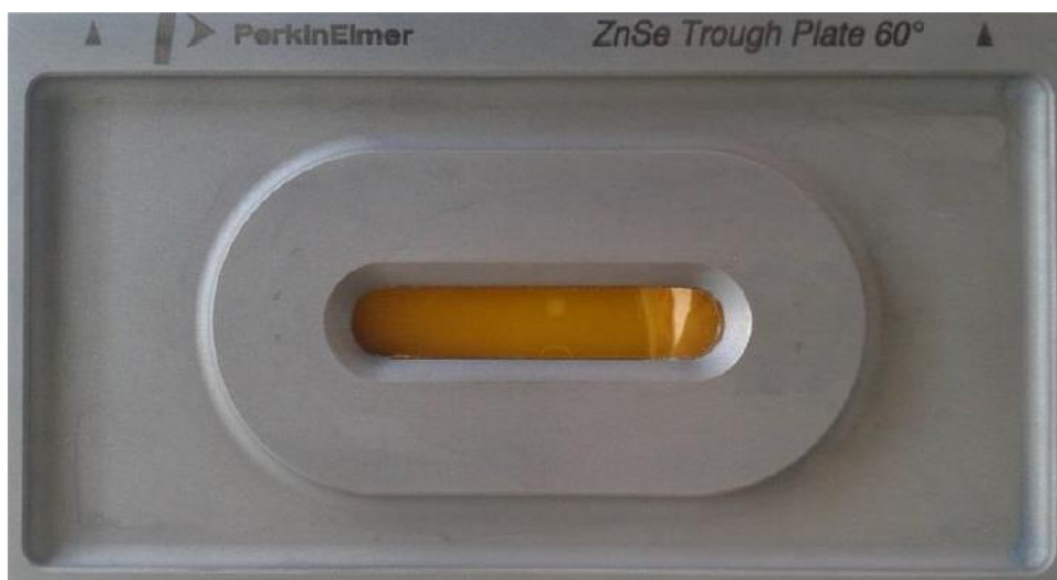
Slika 19. Komponenta dodatka za HATR s kristalom cinkovog selenida za praškaste i kapljevite uzorke 13
