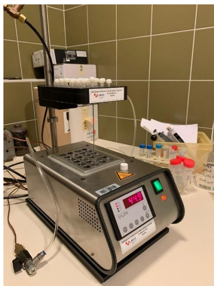
Slika 10. Uređaj za uparavanje uzoraka EC-1V-130 (VLM, Njemačka)
