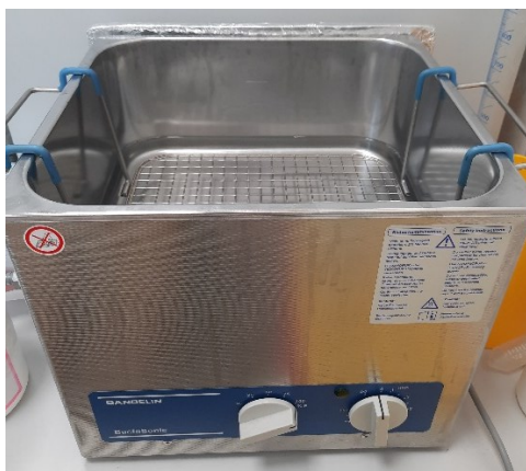
Slika 22. Ultrazvučna kupelj (BactoSonic, Bandelin, Berlin, Njemačka). Izvor: autor.
