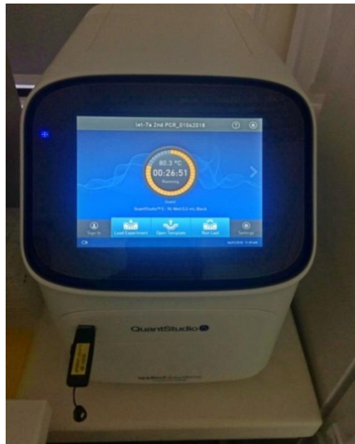
Slika 4. Uređaj QuantStudio 5 Real-Time PCR
