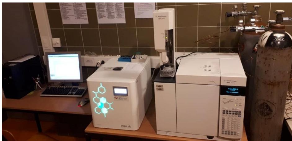
Slika 3.3. Instrumenti korišteni tijekom istraživanja. S lijeva na desno: računalo, generator vodika, plinski kromatograf s automatskim uzorkivačem.
