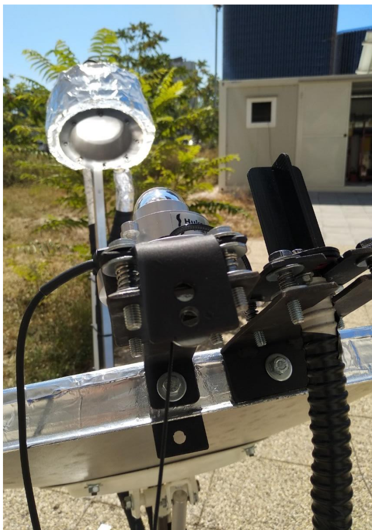
Slika 3.10. – Spojeni fotoosjetljivi osjetnik i piranometar
