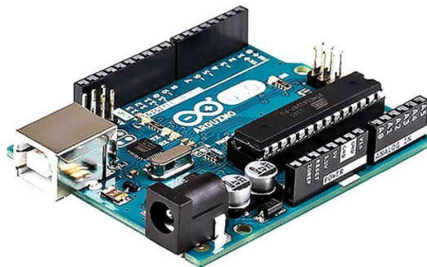
Slika 2.2 Arduino Uno mikrokontroler [2]
