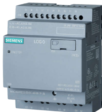
Slika 2.1 Siemens LOGO!8 PLC kontroler [1]
