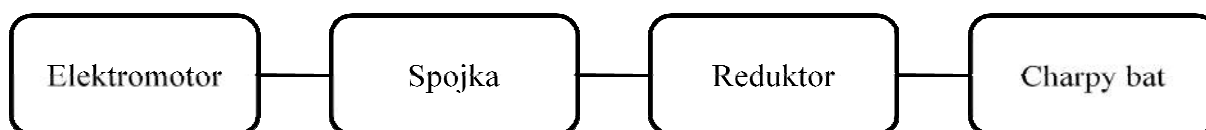
Slika 3.1 Blok dijagram automatizacije Charpy bata
