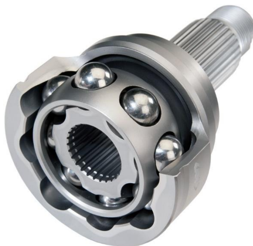
Slika 4.4 – Homokinetički zglob iz automobila [20]
