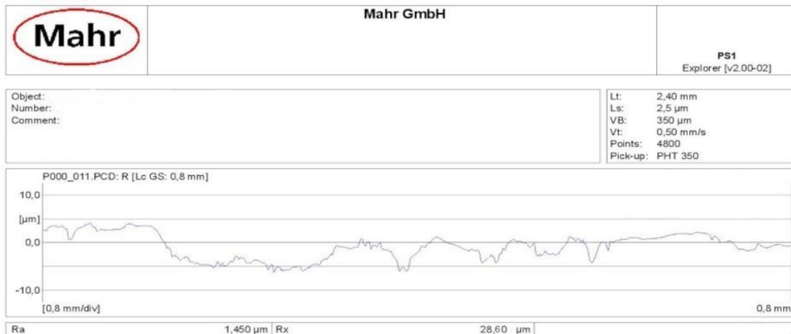
Slika 37. Hrapavost površine uzorka tretiranog u otopini željezovog (III) klorida 72 sata na temperaturi od 40 °C [30]
