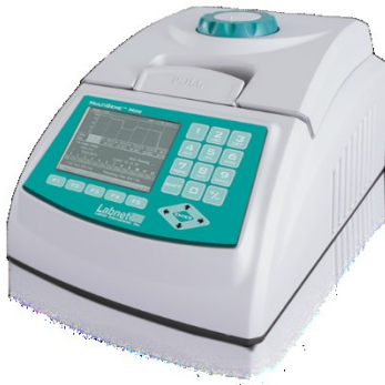
Slika 2. Uređaj za PCR (Thermocycler)
